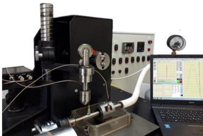
**Рисунок 7** – Стенд для оценки демпфирующих характеристик материалов и деталей триботехнических узлов.
